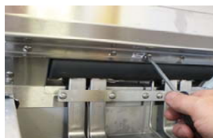
Billede 1 Brug en flad skruetrækker til at fjerne skruen mærket "Nulstillingsknap" (Fuld gryde vist). SELV14T nulstillingsknapper under de udvendige skruer.
