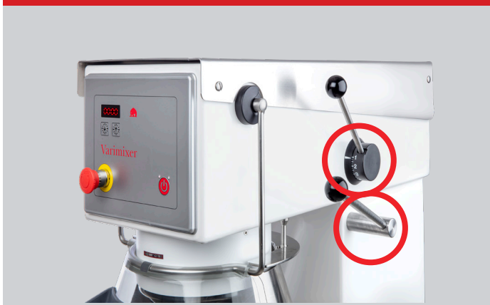
VL-1 – Manuel hastighedsregulering og manuel kedelsænkning
