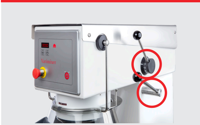
VL-1 – Manuel hastighedsregulering og manuel kedelsænkning
