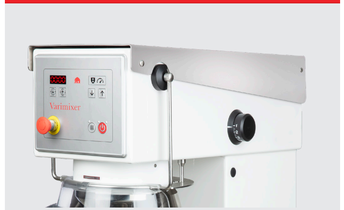
VL-1S – Automatisk hastighedsregulering og automatisk kedelsænkning
