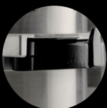
Automatisk fastspænding og centrering af kedel
