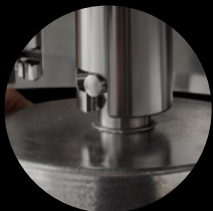
Fastgørelse af værktøj Nem selvåbende bajonetaksel
