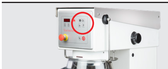
VL-1S Automatisk hastighedsregulering og kedelsænkning
