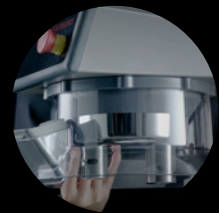
Magnetisk sikkerhedsskærm Nem et montere og afmontere
