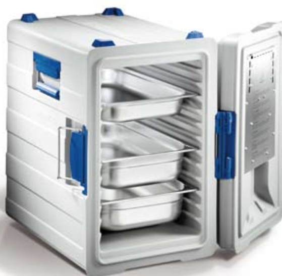
BLT 620 KBRUH (med tilbehør) Frontbetjent med gradvis regulerbar varmluft-cirkulation (maks. 85 °C) og overophednings-sikring mod uønsket udkogning.
